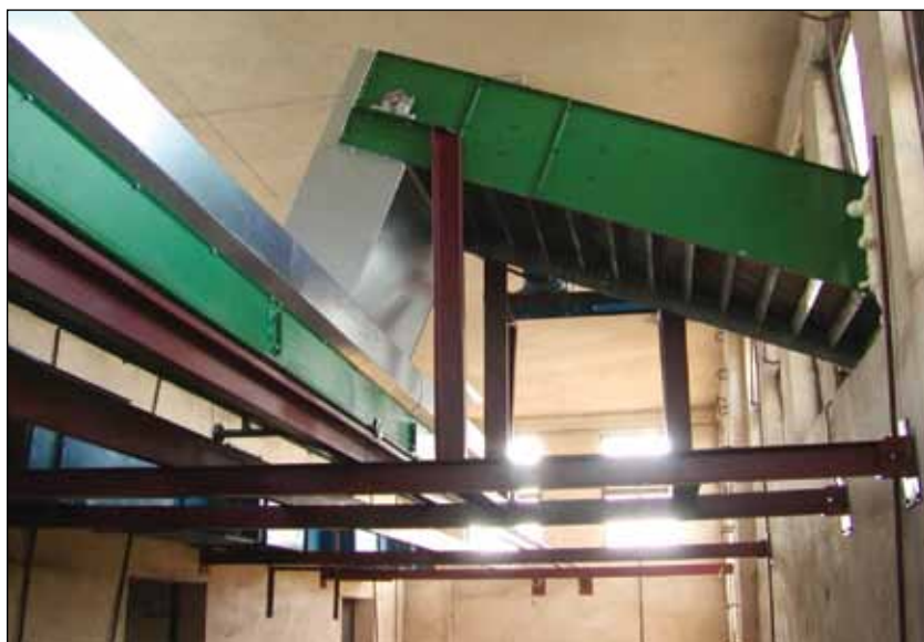
Obr. 2: Kapsový dopravník vyústuje přímo do násypné komory
