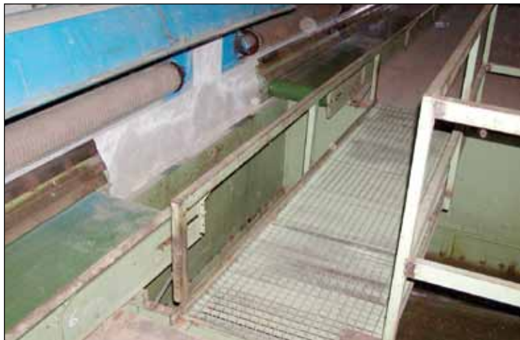
Obr. 7: Zakončení sběrných pásů usušeného chmele a sběrná násypka chmele do klimatizační jednotky
