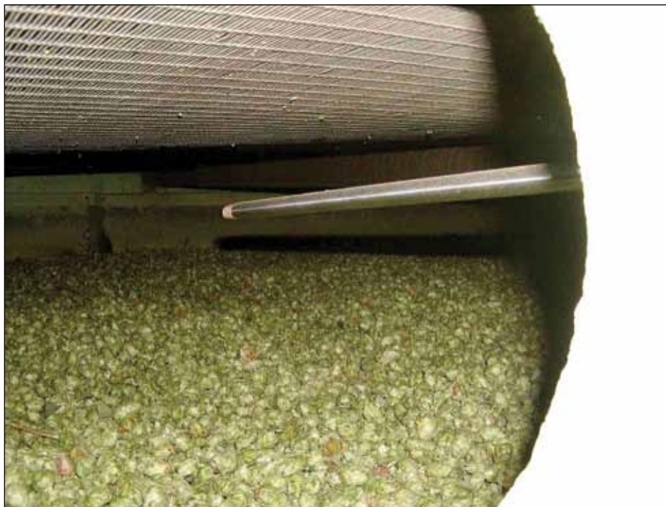
Obr. 3: Detail snímání sondy nad vrstvou sušených chmelových hlávek
