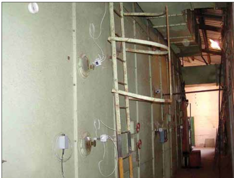
Obr. 4: Pásová sušárna se snímacími sondami teploty a vlhkosti nad vrstvou chmele
