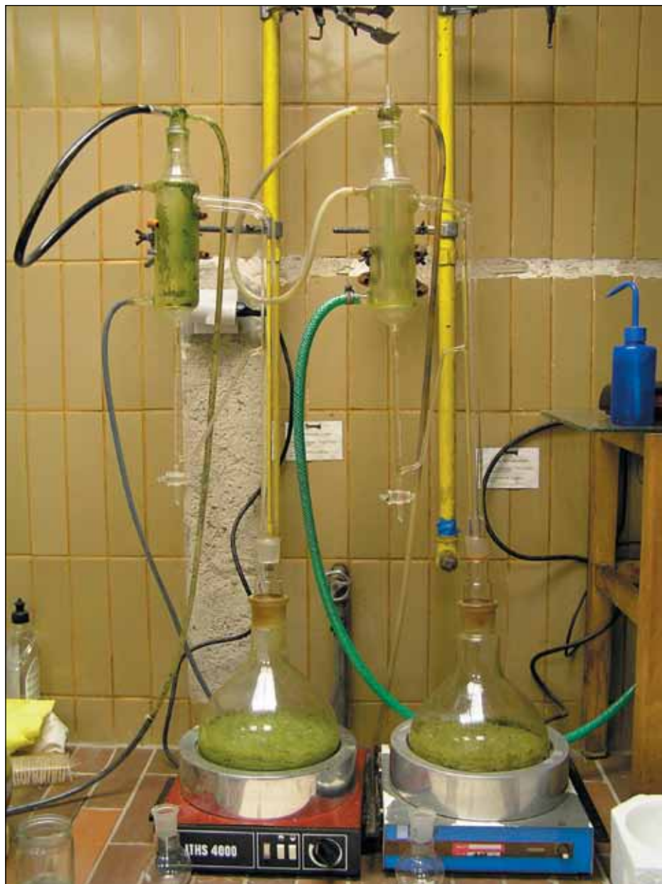
Obr. 12 Aparatura na izolaci chmelových silic destilační metodou
