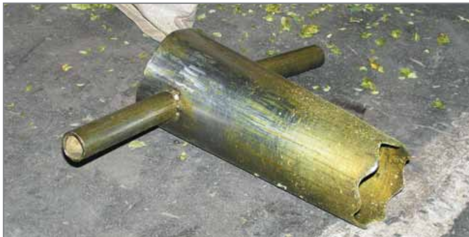
Obr. 3 Zařízení pro odběr vzorků chmele z hranolů
