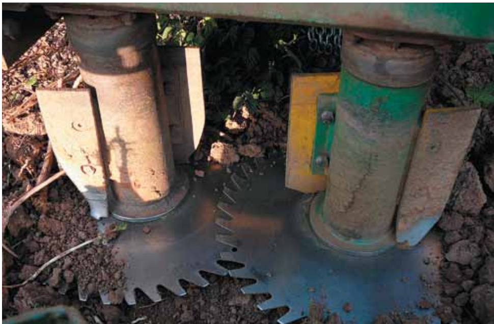
Obr. 8: Detail řezných kotoučů a odhazovacích křidélek
