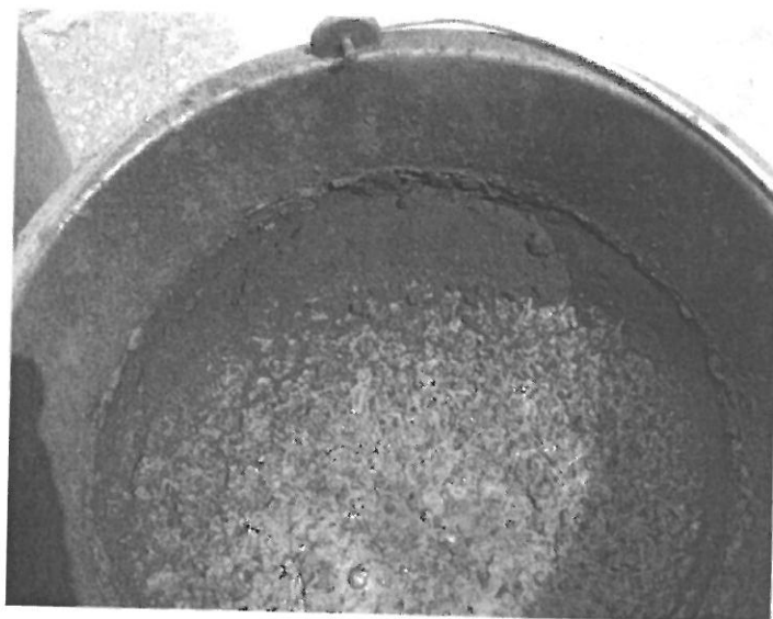
Obrázek 7: Detail plovoucí vrstvy sazí na hladině sazové vody po vypuštění ze zásobníku pokus D (parametr \lambda = 0,795 )
