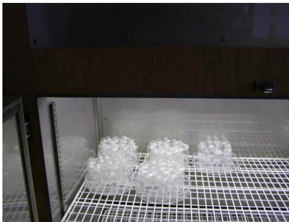
Obrázek 3. Váženky s víčkem se zábrusem utěsněným silikonovou pastou umístěné v termostatu
