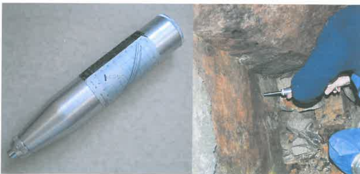
Obr. 2 Vlevo Schmidtovo nárazové kladívko typu N, vpravo měření odrazu Schmidtovým kladívkem v Dole Jeroným (foto: Lednická)
