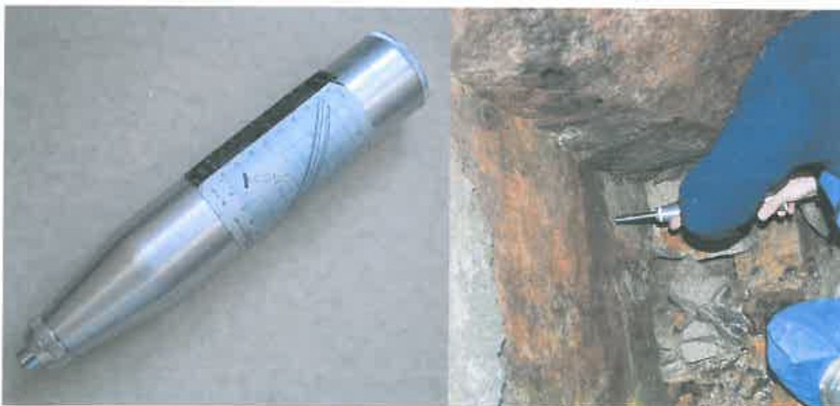
Obr. 2 Vlevo Schmidtovo nárazové kladívko typu N, vpravo měření odrazu Schmidtovým kladívkem v Dole Jeroným (foto: Lednická)
