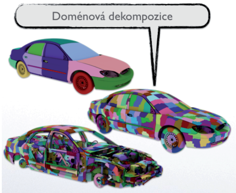
Obr. 4: Škálovatelné paralelní řešiče postavené na doménové dekompozici
