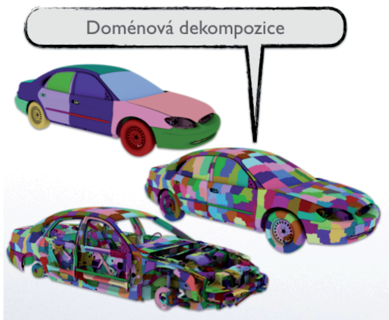
Obr. 4: Škálovatelné paralelní řešiče postavené na doménové dekompozici
