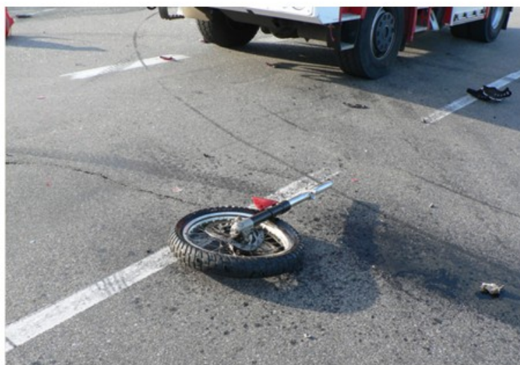
Obr. 4-4 - Ulomené přední kolo s částí vidlice motocyklu Cagiva 500
