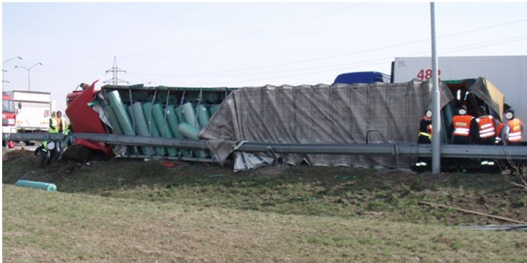
Obr. 4-4 – Pohled na poškození horní části návěsu Berger
