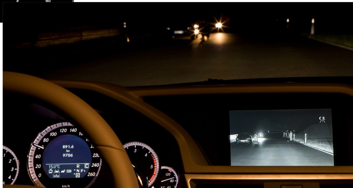
Displej nočního vidění ve sruzeném přístroji třídy E.
