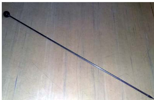
Obr. 1: Kovová tyč délky cca 1 m pro testování hloubky zhutnění ornice (Orig. Dutzi, SRN)
