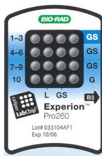
Obrázek 4: Schématické znázornění analytického čipu „Experion Pro260“
