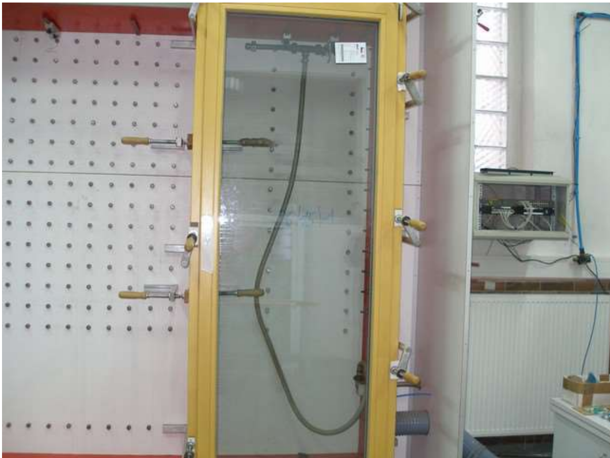
Foto 1: Zkušební zařízení pro stanovení zatékavosti, průvzdušnosti a odolnosti proti větru.
