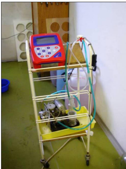
Obr. 3: Měřicí souprava pro analýzu bioplynu
