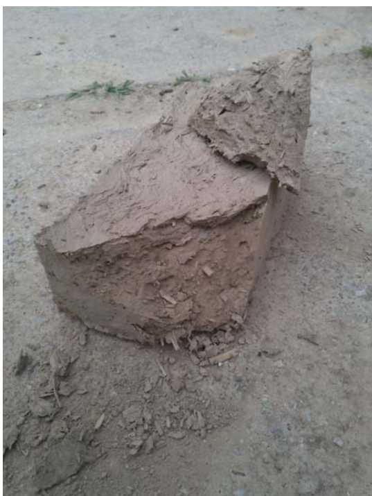
Obr. č. 2.: Test konce sušení
