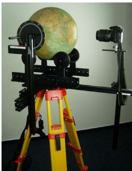
Obr. 2: Digitalizační zařízení pro snímování glóbů
