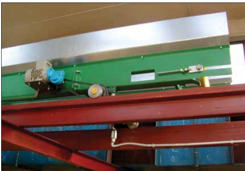
Obr. 4: Detail pohonu rozprostíracího pásu
